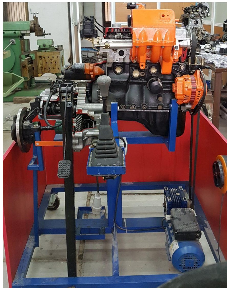
استند موتور و گیربکس پراید- برش خورده
